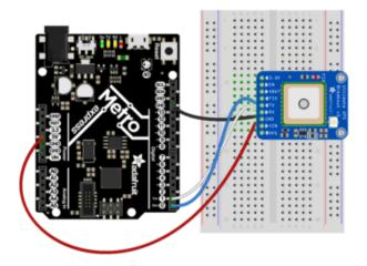
Board 5V or 3.3V to GPS module VIN.
