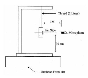
1 METER FROM MICROPHONE TO FAN INTAKE
