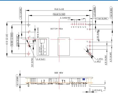
UNIT: mm[inch] PIN: L=3.8±0.25mm TOLERANCE: X.Xmm±0.5mm[X.XX in.±0.02in.]
