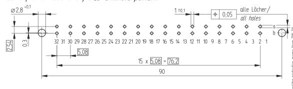
Tauchlötaschluß 0,65 x 0,3 mm / solder terminal 0,65 x 0,3 mm
