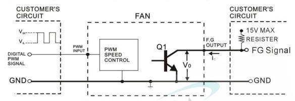
\*TRANSISTOR Q1 AT "ON" POSITION COLLECTOR CURRENT-----Vol=1 V MAX SATURATION VOLTAGE-----\*TRANSISTOR Q1 AT "OFF" POSITION RELEASE VOLTAGE----- $-V_{OH}=15 V MAX$ \*DIGITAL PWM SPEED CONTROL POSITION PWM INPUT VOLTAGE HIGH----
