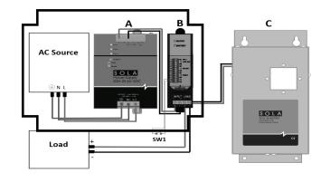
A) AC/DC Power SupplyB) Control Module: SDU 10-24B or SDU 20-24BC) Battery Module: SDU 24-BATEM
