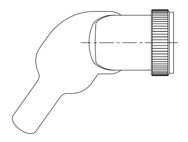
SPIN-LOCK ADAPTER, HEAT SHRINKABLE MOLDED PART, SEALED
