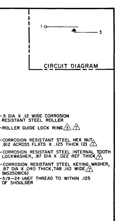
$\sqrt{3}$  TO ADJUST ROLLER DIRECTION REMOVE ROLLER GUIDE LOCK RING. SCREW ROLLER GUIDE DOWN AS FAR AS POSSIBLE, THEN UNSCREW TO DESIRED DIRECTION. SECURE BY REPLACING ROLLER GUIDE
