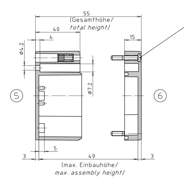
ABS-Gehäuse können durch eine andere Schwindung ca. 0,1–0,25% größer sein als gezeichnete PC-Gehäuse/ Due to a different shrinkage rate of the plastic material, ABS enclosures can be about 0.1 - 0.25% bigger than the PC enclosures shown in the drawing.
