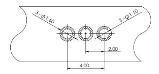
RECOMMENDED P.C.B. LAYOUT TOLERANCE UNSPECIFIED ±0.05mm
